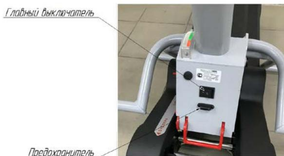
Рис.6. Элементы системы управления на основании рулевой колонки
