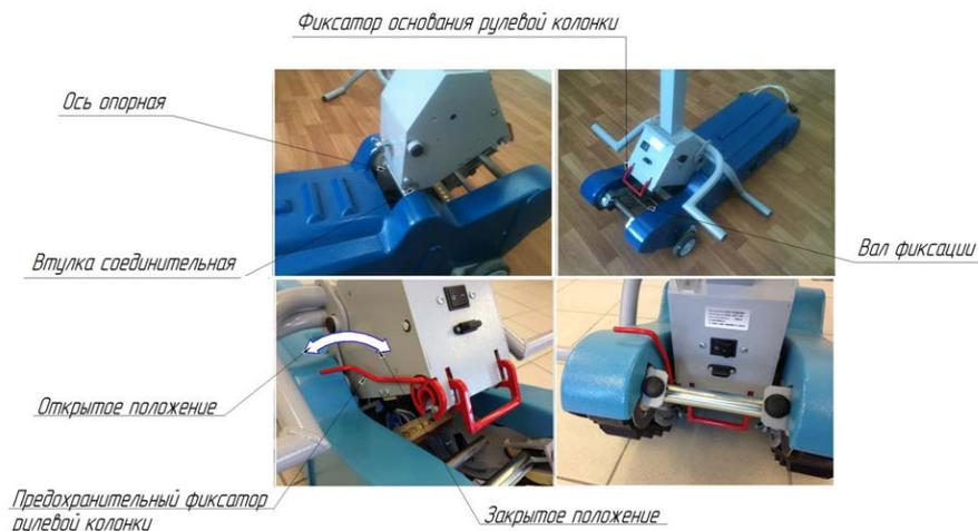
Рис.8. Сборка подъемника
