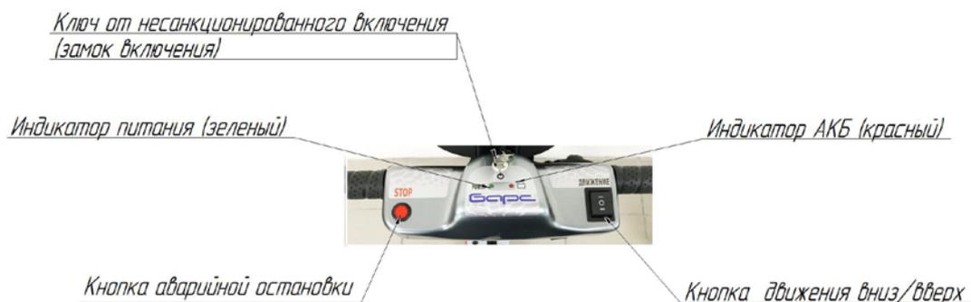
Рис.6а. Элементы системы управления на панели приборов
