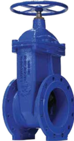
Задвижки с обрезиненным клином и не выдвигаемым чугуно-фланцевым шпинделем применяются как запорное и регулирующее устройство на трубопроводах транспортирующих холодную, горячую воду и нейтральные среды.
