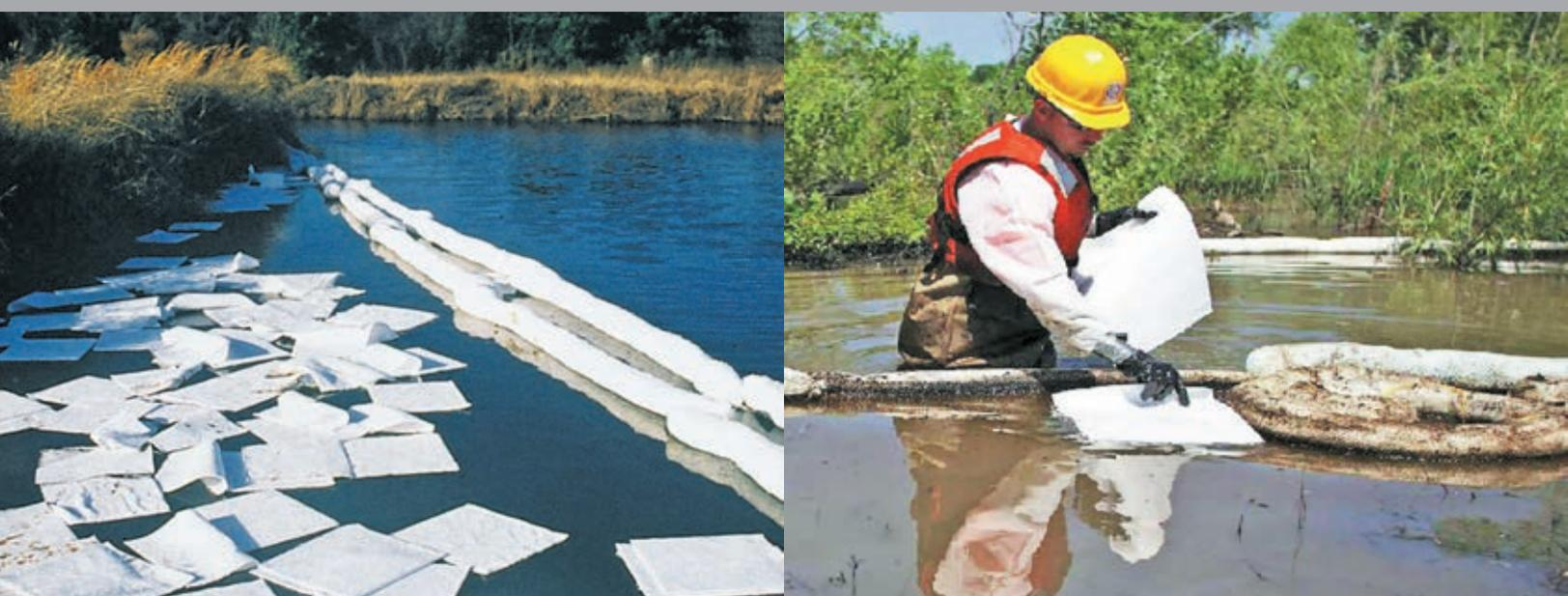
Масловпитывающие сорбенты серии СТАНДАРТ используются для сбора проливов нефтепродуктов (бензин, керосин, мазут и д.р.), сырой нефти, смазочных, гидравлических жидкостей и других неполярных жидкостей в любых поверхностях, где необходимо устранить или контролировать проливы.
