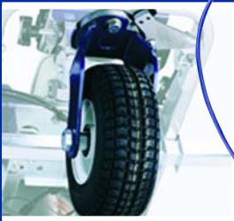
Переднее вращающееся колесо, оборудованное системой Fast Track™
