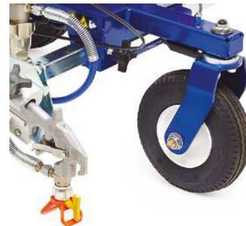
Поворачиваемое переднее колесо
