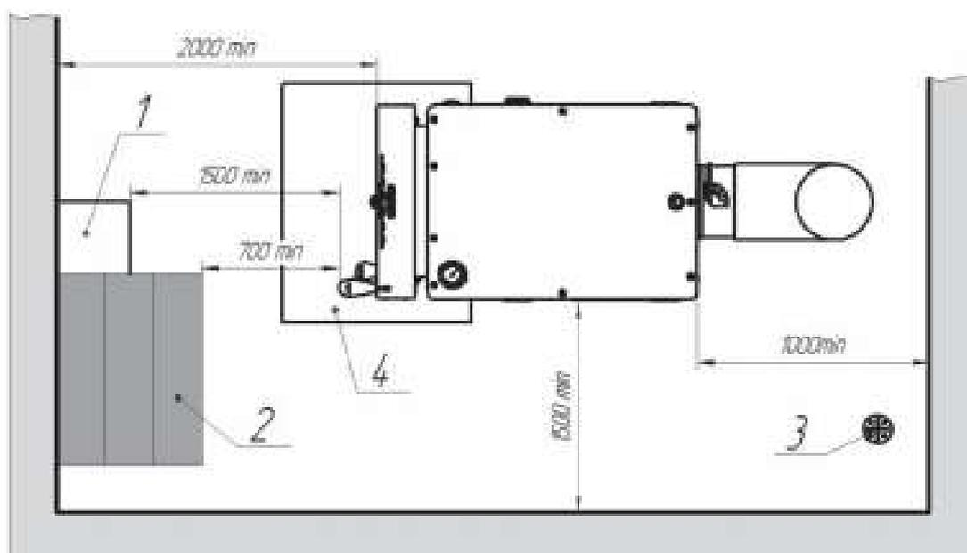
[1] Запас твёрдого топлива. [2] Лестница и другие выступающие конструкции. [3] Дренажное отверстие. [4] Предтопочный лист.
