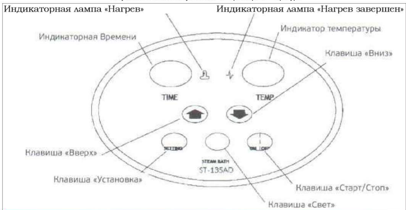
Рисунок 3. Указания по установке контроллера температуры
