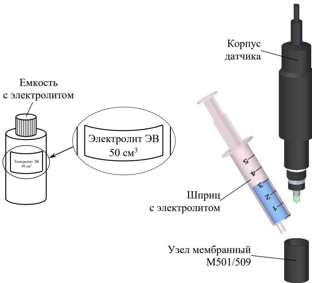
Рисунок 2.2 – Заливка (добавление) электролита
