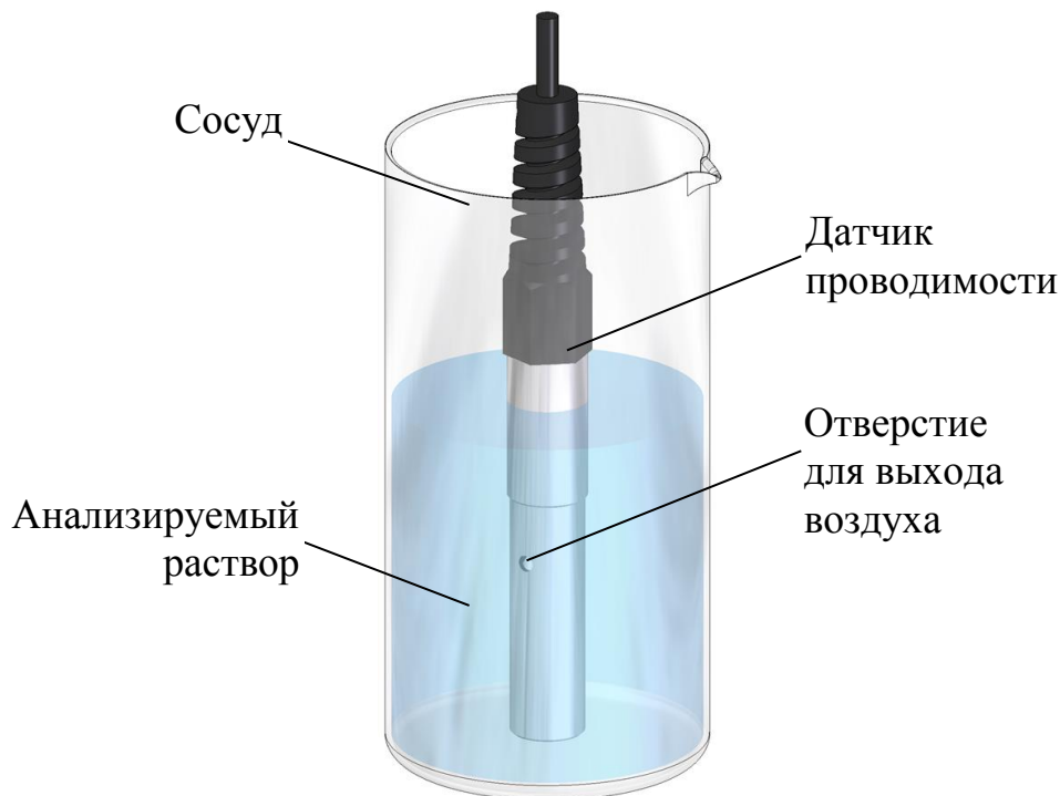
Рисунок 2.3 – Проведение измерений погружным методом
