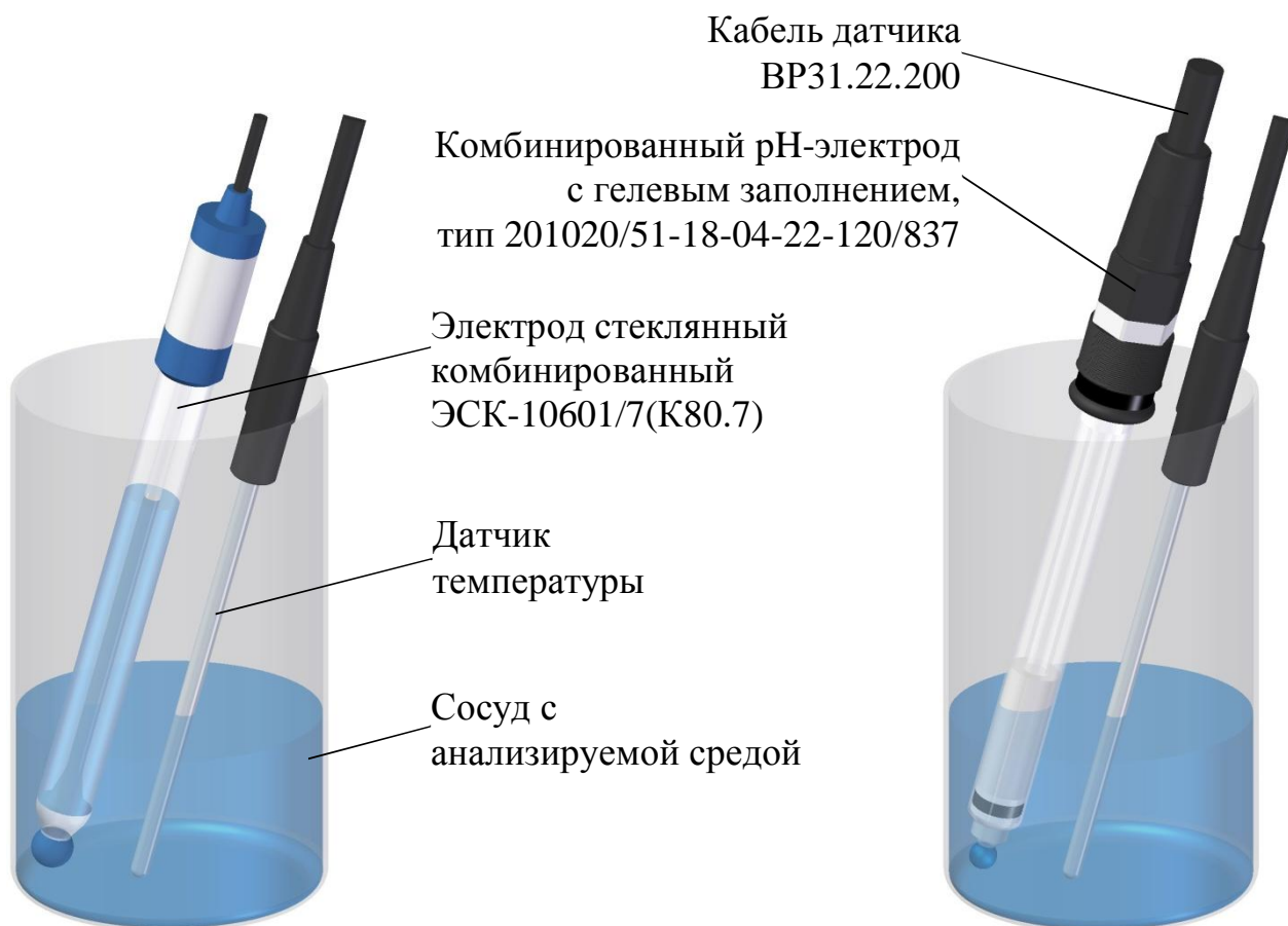
Рисунок 2.15 - Пример расположения комбинированного электрода и датчика температуры при проведении измерений
