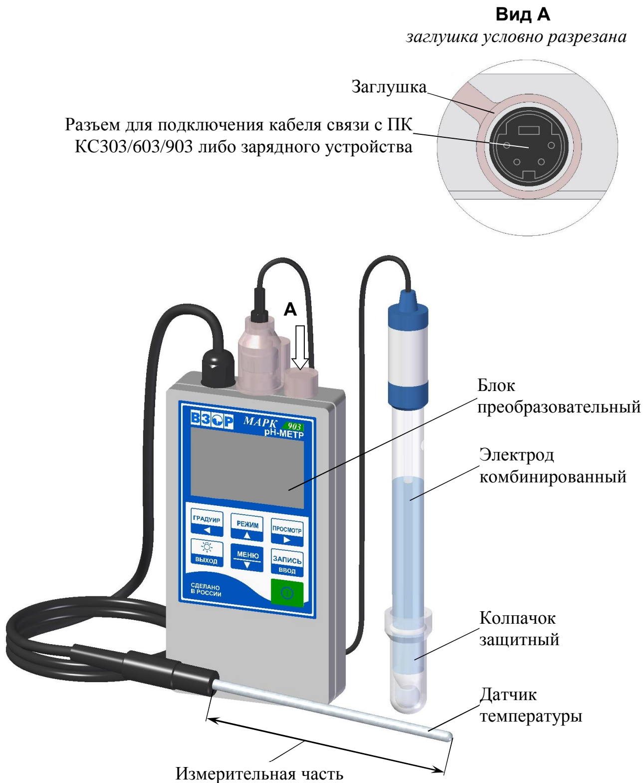
Рисунок 1.1 - рН-метр МАРК-903 (вид спереди)
