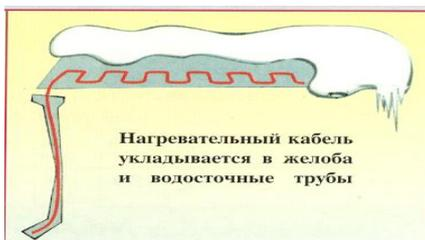
Нагревательный кабель укладывается в желоба и водосточные трубы
