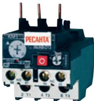
Предназначены для защиты электродвигателя от сверхтоков при перегрузках и при возникновении несимметричного режима при обрыве одной фазы питающего напряжения. Применяются в цепях переменного тока 50 Гц напряжением до 690 В. Выпускаются на номинальные токи от 1 до 65 А.
