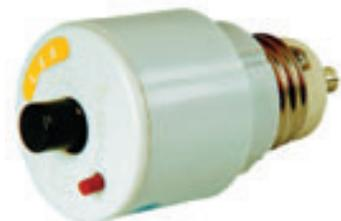
Могут быть использованы при переменном и постоянном токе до 32 А при частоте 50 Гц и номинальном напряжении до 380 В для защиты от перегрузок и коротких замыканий. Они применяются вместо традиционных плавких предохранителей "пробок" и ввинчиваются в стандартный патрон E27.
