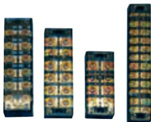
Предназначены для электрического и механического соединения проводов. Могут использоваться в сети переменного тока частотой 50-60 Гц, напряжением до 660 В, или в сетях постоянного тока, напряжением до 440 В, с номинальным током от 15 до 100 А.
