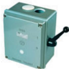
Выключатели нагрузки серии QS55 предназначены, главным образом, для прямого запуска, остановки трехфазного асинхронного электродвигателя при работе в сети переменного тока частотой 50 Гц, напряжением до 500 В и максимальной номинальной нагрузкой до 7,5 кВт. Также могут использоваться для включения, выключения и переключения нагрузки, переключения от одной цепи к другой. Выключатели нагрузки выпускаются трех типов:
