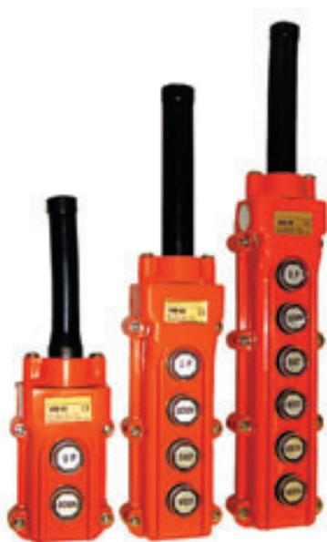
Предназначены для коммутации электрических цепей управления подъемными механизмами, кран-балками. Корпус выполнен из термостойкой пластмассы и снабжен герметичной прокладкой и защитным сальником.
