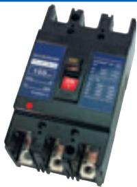
Автоматические выключатели серии NF-CS предназначены для проведения тока в нормальном режиме и отключения тока при коротких замыканиях, перегрузках, а также до 30 включений и отключений электрических цепей в сутки. Рассчитаны для эксплуатации в электроустановках с номинальным рабочим напряжением до 660 В, частотой переменного тока 50 и 60 Гц, номинальным рабочим током от 60 до 630 А, номинальным напряжением изоляции до 600 В.
