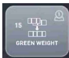
Рисунок 7.2 – Клавиша-индикатор GreenWeight: колесо может быть отбалансировано одним грузом 15 г
