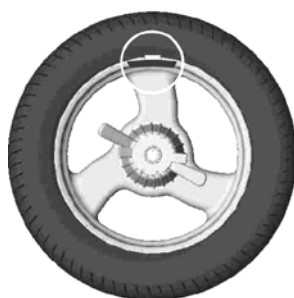
Рисунок 6.5 – Груз установлен в «12 часов»
