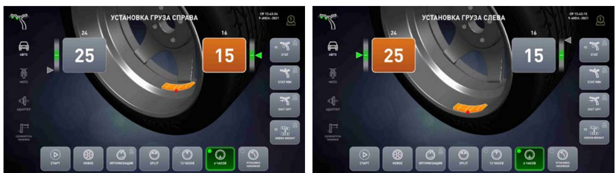
а – установить ленточный груз 15 г справа б – установить ленточный груз 25 г слева
