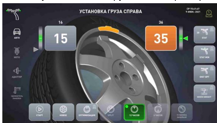
а – экран при установке груза со скобой
