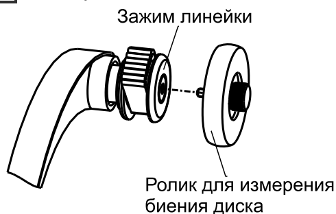
Рисунок 7.7 – Ролик для измерения биений
