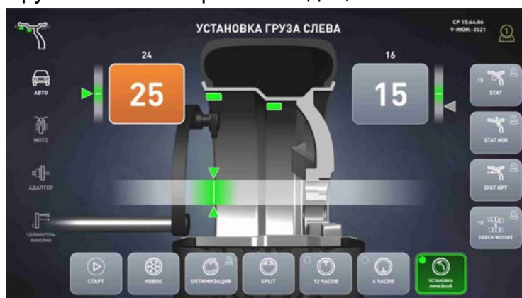
Рисунок 5.10 – Экран при установке груза линейкой
