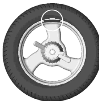
б - груз установлен в положение «12 часов»
