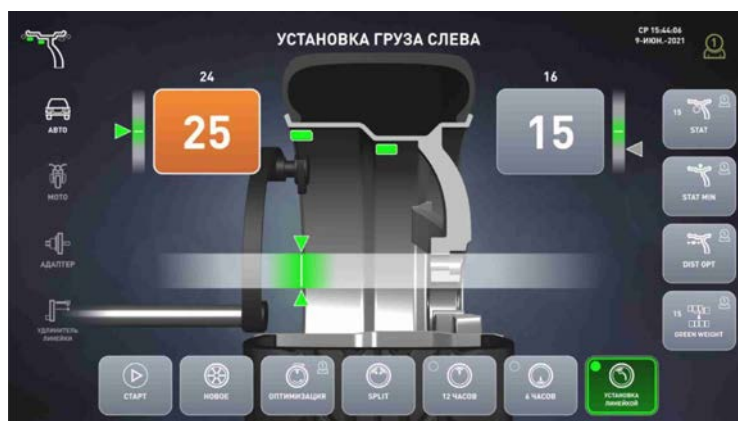
в – установка груза линейкой
