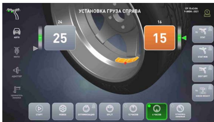
б – установка груза в «6 час»
