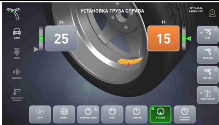
Рисунок 5.8 – Установка в «6 часов» справа
