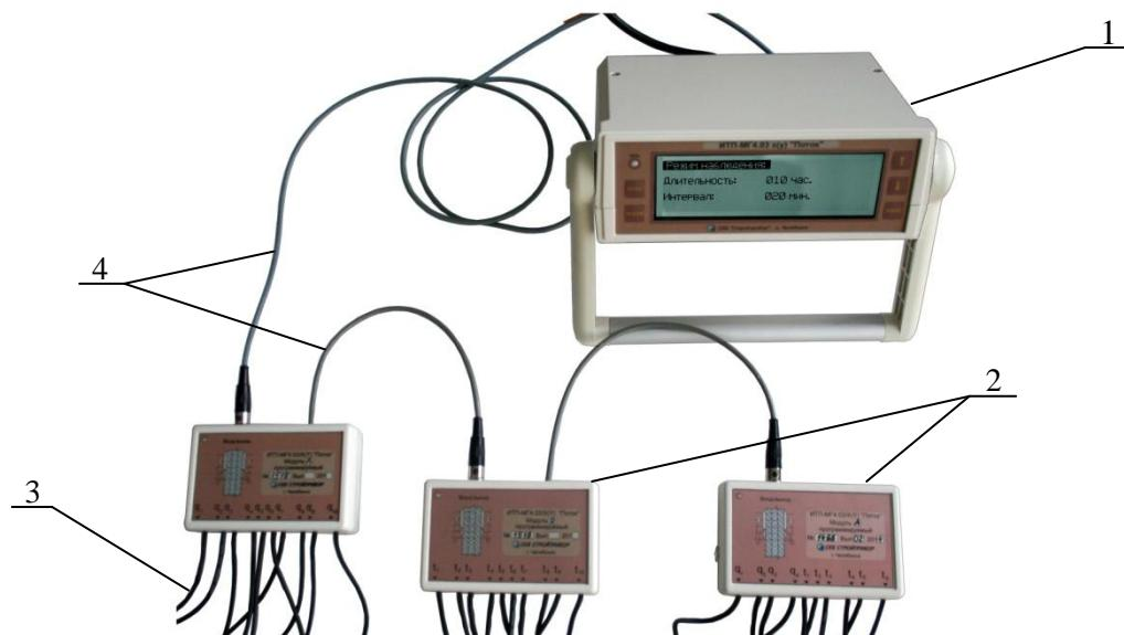
1 – электронный блок; 2 – модули; 3 – кабели датчиков теплового потока и температуры;
