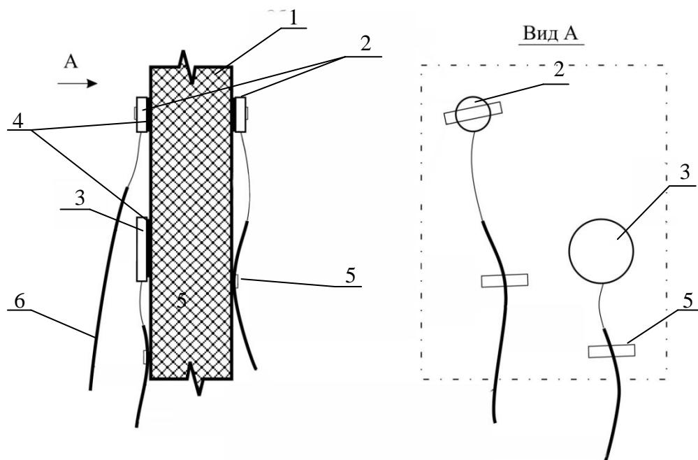
1 – объект контроля; 2 – датчики температуры; 3 – датчик теплового потока;
