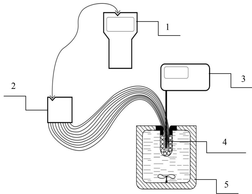
1 – электронный блок, 2 – модуль, 3 – лабораторный термометр,
