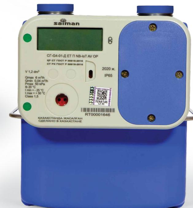
Счетчик газовый **CG-G4-01-D ET P NB-IoT AV OP** предназначен для измерения расхода газа в квартирах и домах с газовыми колонками и плитами. Межосевое расстояние – 110 мм; 150 мм.
