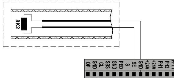
Малюнок 14. Схема підключення резистивної кромки безпеки 8,2 кОм
