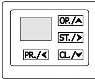
Малюнок 17. Панель для налаштування двигуна
