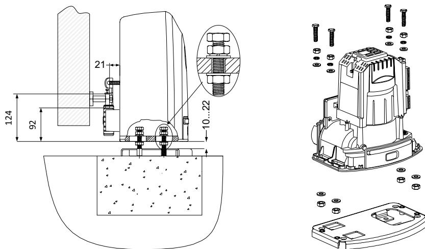
*Малюнок 6. Регулювання положення двигуна
