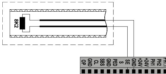
Рисунок 14. Схема подключения резистивной кромки безопасности 8,2 кОм
