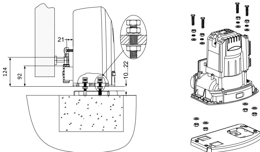
Рисунок 6. Регулировка положения привода
