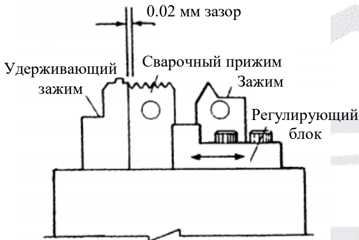
Рис. 24 Сварочный прижим и удерживающий зажим
