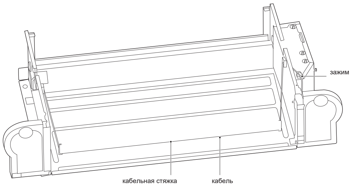
Рис 5-21 кабельная диаграмма (фанкойлы с DC мотором)
