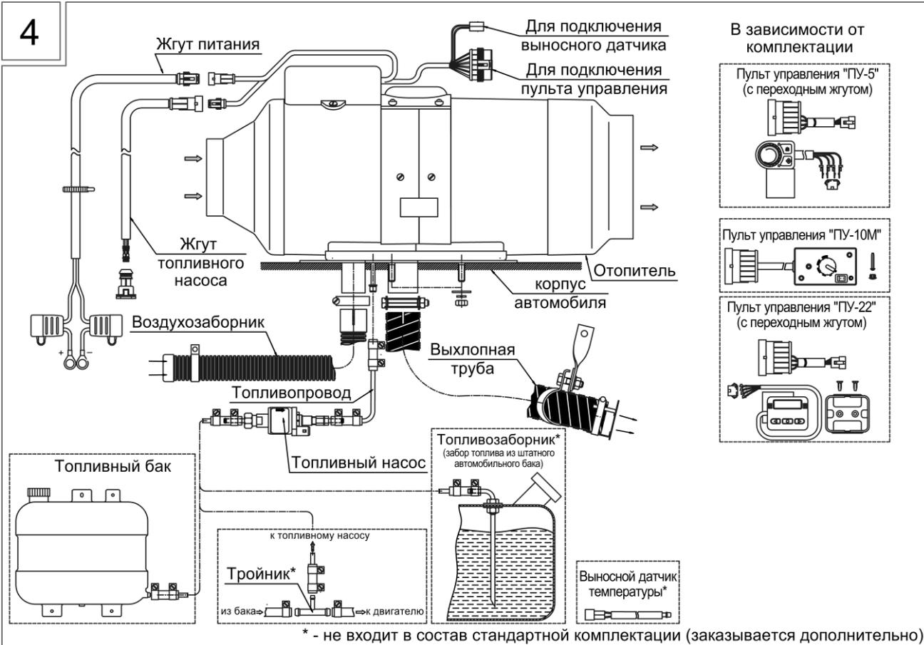
**Схема соединений основных узлов и деталей отопителей PLANAR-9D исполнения S**
