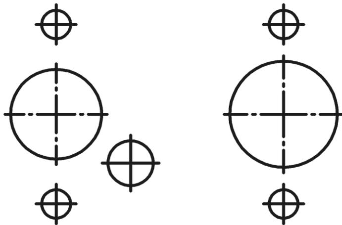
*Монтажные отверстия для отопителя PLANAR-4DM2*
