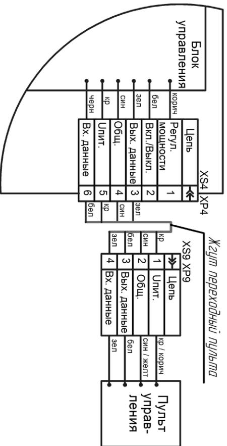
*Схема подключения пульта ПУ-10M*
