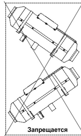
\* - Вид на отопитель со стороны входа нагреваемого воздуха (со стороны вентилятора).
