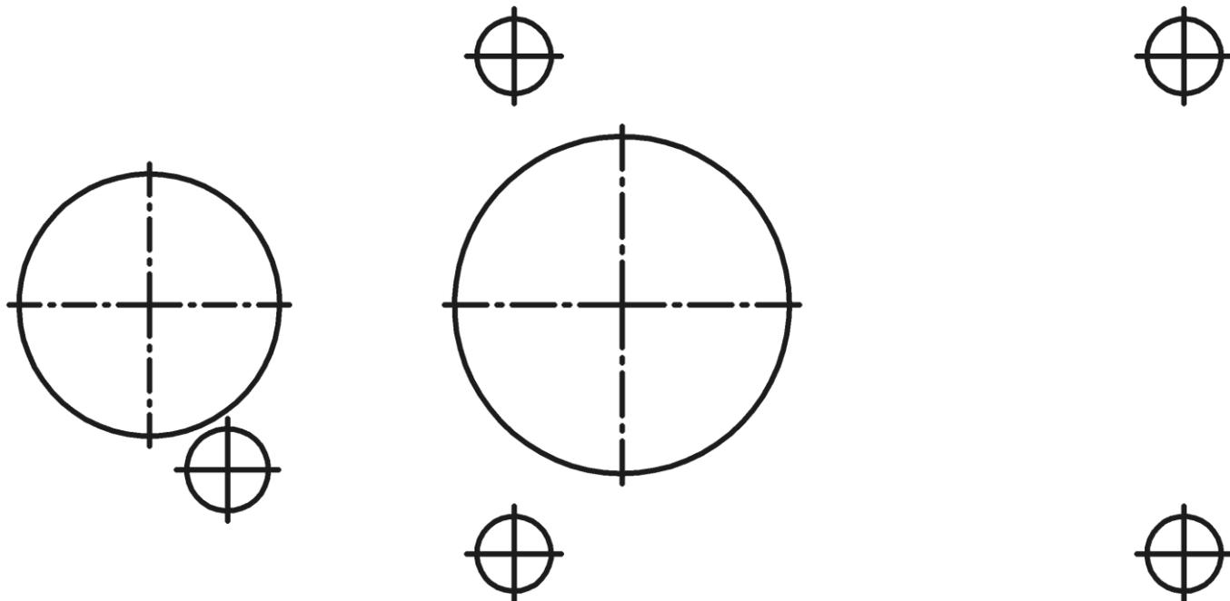
*Монтажные отверстия для отопителя PLANAR-8DM*
