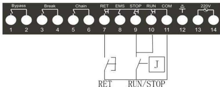
(7) Клемма заземления 12
