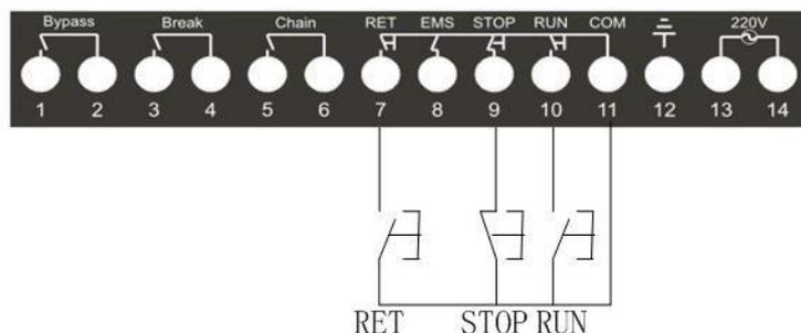
2-проводной способ подключения, как показано на схеме ниже:
