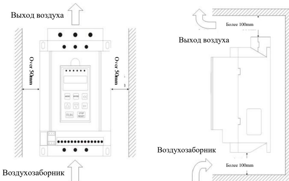
Принципиальная схема установки устройства плавного пуска серии CDRA-K3
