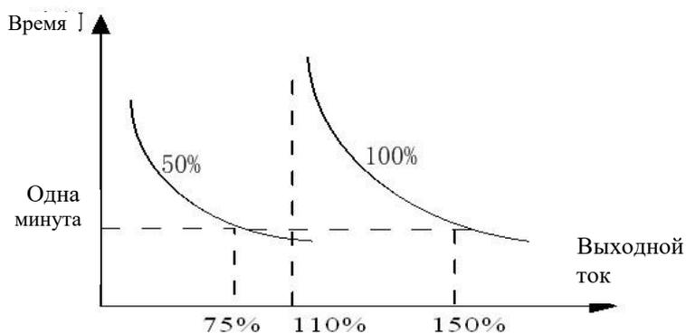
Обратная временная характеристическая кривая защиты от перегрузки
