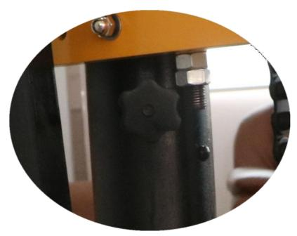
1) Опустите груз, отпустив ручку. Скорость опускания можно регулировать с помощью спусковой ручки.
