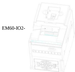
Способ установки EM60-IO2-3
