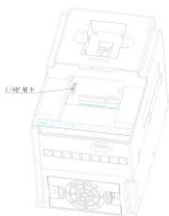
Способ монтажа карты расширения IO
