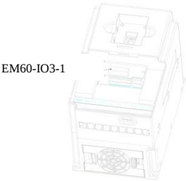
Способ установки EM60-IO3-1
