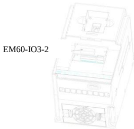
Способ установки EM60-IO3-2
