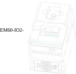
Способ установки EM60-IO2-2
