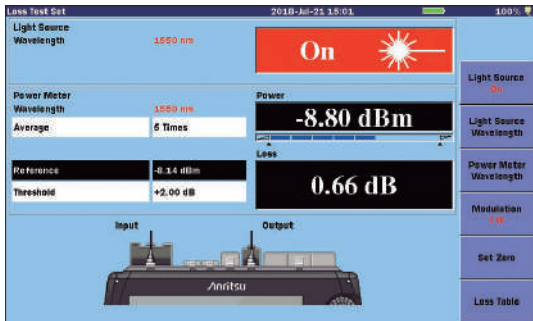
Измерение оптических потерь
