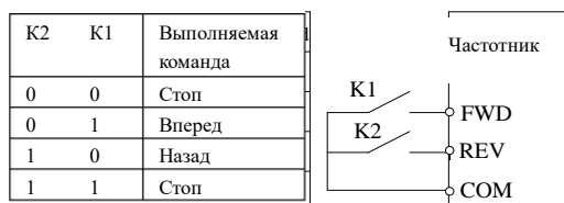
Рис.6-13 Двухпроводной режим управления 1
