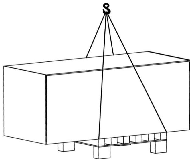
Рисунок 1 – Схема транспортировки машины в упаковке
