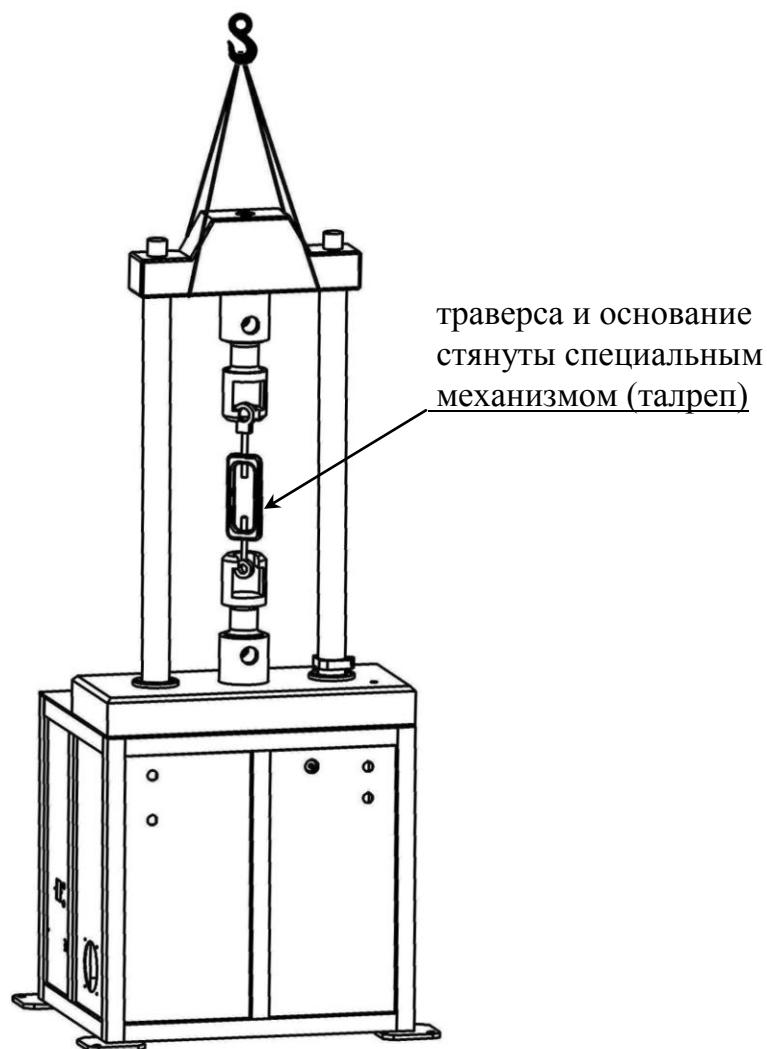
Рисунок 2 – Схема транспортировки машины без упаковки
