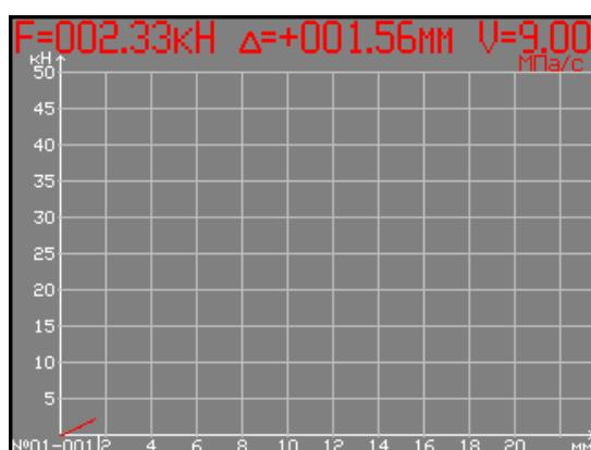
Нагружение образца происходит автоматически со скоростью установленной пользователем (например  $V=9$  МПа/с).
