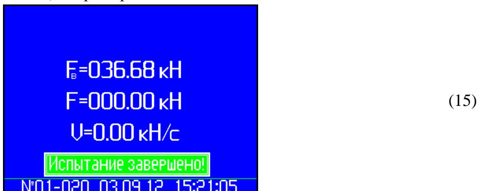
Значения  $F_b$  и дата испытаний автоматически заносится в архив.
