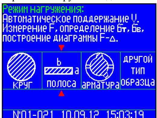
2.4.1.6 Перемещая курсор клавишами  $\uparrow$ ,  $\downarrow$  выбрать из предлагаемого ряда ( круг, арматура, полоса (квадрат), другой тип образца), требуемый тип образца, например «арматура» и зафиксировать клавишей **ВВОД**. На экран выводятся значения скорости нагружения  $V$ , площади сечения образца  $S_0$  и мигающее значение диаметра образца  $d_{\text{ном}}$ . Дисплей имеет вид, например:
