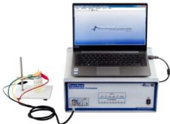
Электрохимическая рабочая станция CS (потенциостат / гальваностат) содержит быстрый цифровой генератор функций, высокоскоростную схему сбора данных, потенциостат и гальваностат. Обладая высокими показателями стабильности и точности, с использованием современного аппаратного обеспечения и хорошо функционирующего
