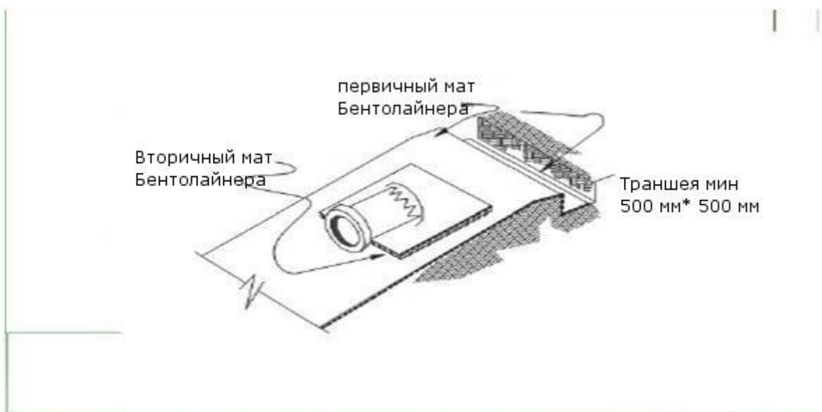
Рисунок 4б. Изометрическое изображение горизонтального внедрения трубы в законченном виде.
