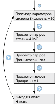
Просмотр параметров системы (Система для крыши)
