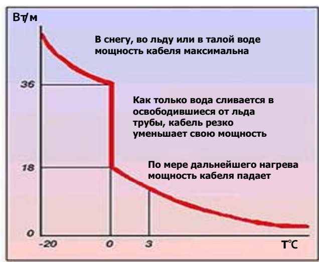
Рис.7. Теплоотдача саморегулирующихся кабелей в воде и на воздухе.
