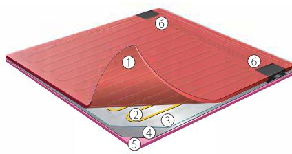
1. Покрытие – прорезиненный пластик, прочная поверхность
