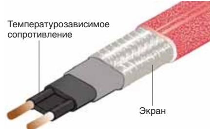
Управление мощностью происходит независимо по всей длине кабеля в соответствии с температурой окружающей среды каждого участка кабеля. При увеличении температуры среды выделяемая мощность кабеля снижается. Благодаря этой возможности саморегулирования предупреждается перегрев отдельных участков кабеля, например, при его перекрещивании или соприкосновении с другим кабелем.
