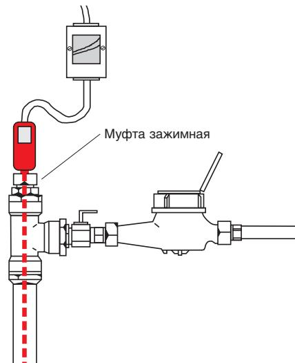
Для кабеля **DEVIaqua™ 9T (DTIV-9)** необходимо точно измерить участок трубопровода, так как этот кабель нельзя обрезать или сворачивать в петлю.
