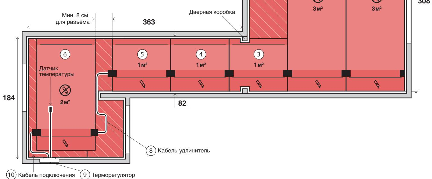
**Пример 4. Система «Полное отопление» через деревянный пол.**
