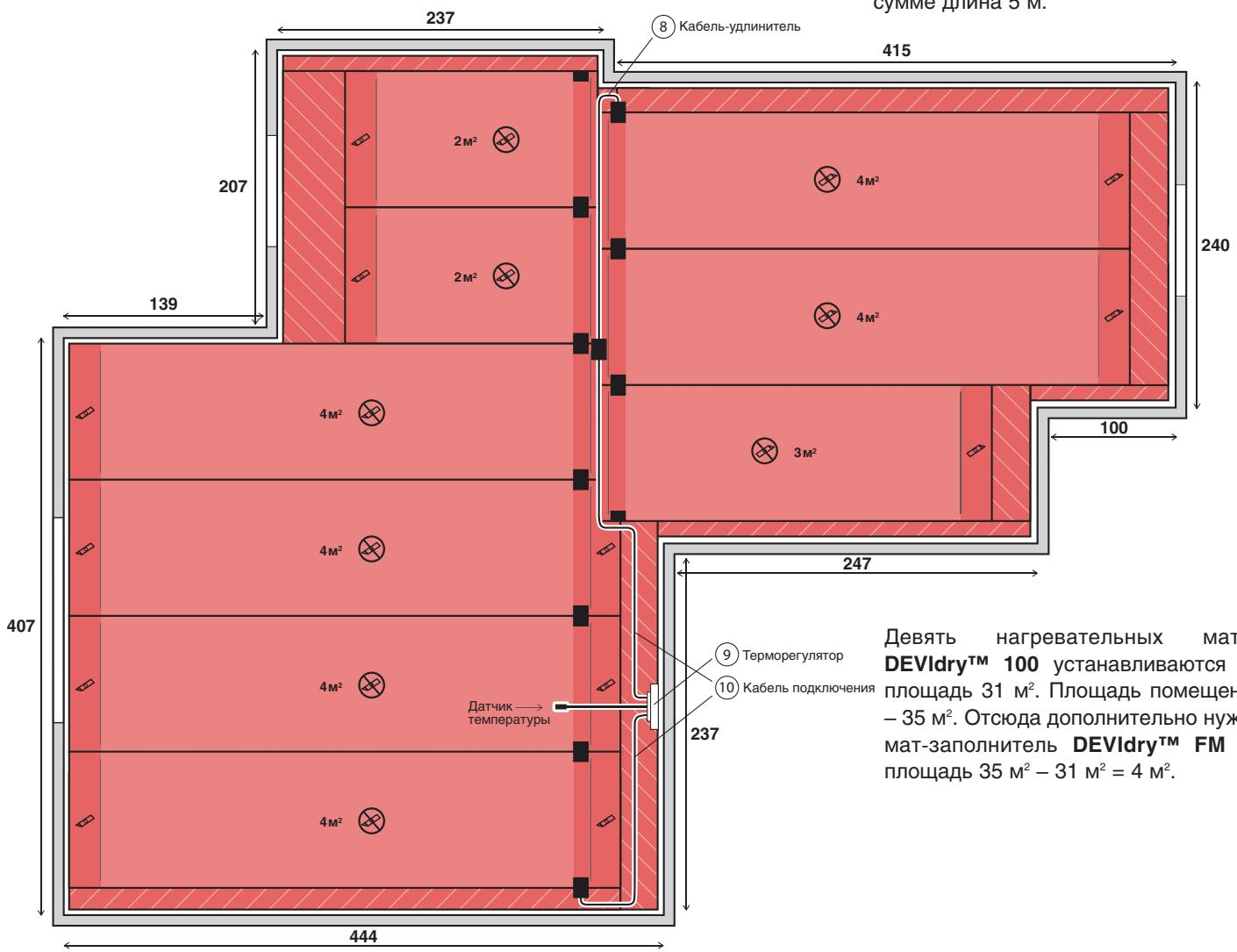
Девять нагревательных матов **DEVIdry™ 100** устанавливаются на площадь 31 м<sup>2</sup>. Площадь помещения – 35 м<sup>2</sup>. Отсюда дополнительно нужен мат-заполнитель **DEVIdry™ FM** на площадь 35 м<sup>2</sup> – 31 м<sup>2</sup> = 4 м<sup>2</sup>.
