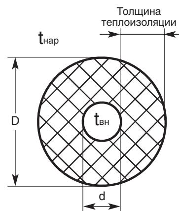
В таблице ниже показана зависимость теплопотерь трубопроводов различных диаметров от толщины теплоизоляции и разности температуры между поверхностью трубы и наружным воздухом.
