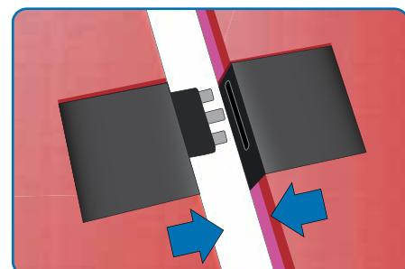
Используйте специальный ключ для соединения и разъединения разъемов.
