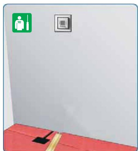
Возможно подключение регулятора через розетку – используется набор **DEVIdry™ Plug Kit 100** с блоком защиты. Регулятор **DEVIdry™ C** и блок защиты **DEVIdry™ CD** могут крепиться на поверхность стены, а провода прятаться в пластиковые короба, монтируемые на поверхности стены.
