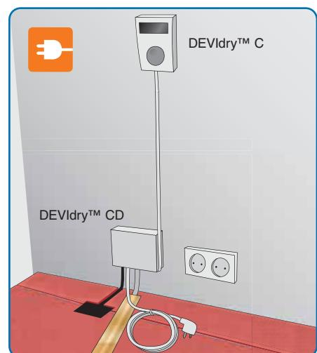
9. Установите терморегулятор. Для стационарной установки в монтажную коробку используется набор **DEVIdry™ Pro Kit** с **DEVIreg™ 535**. Для монтажа регулятора и датчика температуры необходимо штробление стены. В штробе устанавливаются монтажная коробка для регулятора, гофротрубы для датчика температуры пола и для кабеля подключения к регулятору.
