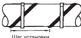
По таблице ниже можно определить шаг витков кабеля после расчета необходимой длины на 1 метр трубы.
