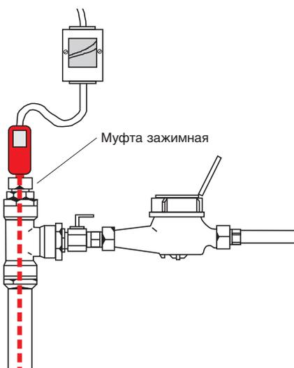
Для кабеля **DEVlaqua™ 9T (DTIV-9)** необходимо точно измерить участок трубопровода, так как этот кабель нельзя обрезать или сворачивать в петлю.
