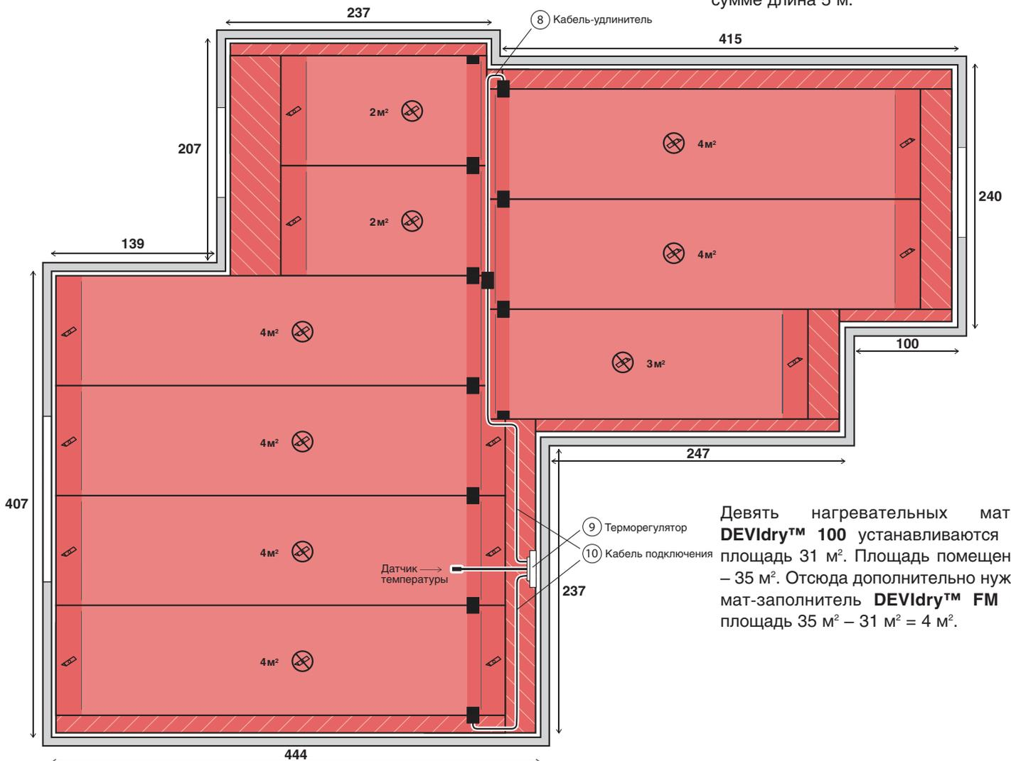
Девять нагревательных матов **DEVIDry™ 100** устанавливаются на площадь 31 м<sup>2</sup>. Площадь помещения – 35 м<sup>2</sup>. Отсюда дополнительно нужен мат-заполнитель **DEVIDry™ FM** на площадь 35 м<sup>2</sup> – 31 м<sup>2</sup> = 4 м<sup>2</sup>.
