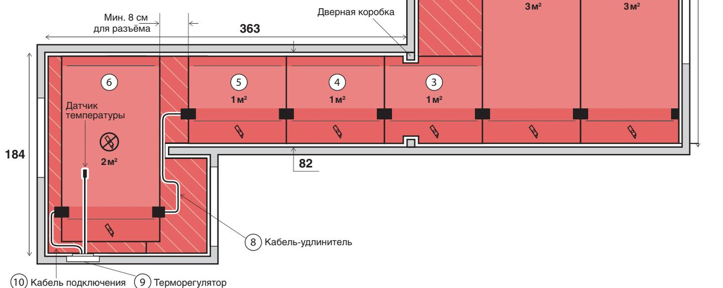
**Пример 4. Система «Полное отопление» через деревянный пол. Жилая комната большой площади и сложной формы. Площадь 35 м<sup>2</sup>**
