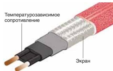
Управление мощностью происходит независимо по всей длине кабеля в соответствии с температурой окружающей среды каждого участка кабеля. При увеличении температуры среды выделяемая мощность кабеля снижается. Благодаря этой возможности саморегулирования предупреждается перегрев отдельных участков кабеля, например, при его перекрещивании или соприкосновении с другим кабелем.
