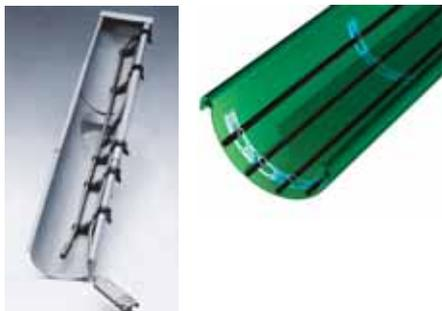
В водосточных трубах для крепления нагревательного кабеля большой мощности (25-30 Вт/м) рекомендуется использовать металлические элементы крепления. Например, можно применить стальной трос (нержавеющий или с пластиковым покрытием) или оцинкованную металлическую цепь **DEVIchain™**, которые являются армирующим элементом и предотвращают обрыв кабеля при движении намерзающего льда в трубе. В этом случае кабель закрепляется на тросе или цепи при помощи отрезков ленты **DEVIfast™** или специ-
