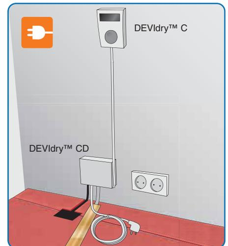
10. Проверьте сопротивление кабеля и сопротивление изоляции. Подключите напряжение. Проверьте систему – почувствуйте тепло на поверхности всех нагревательных матов. Теперь можно укладывать покрытие.
