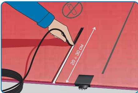
В полученном вырезе-канавке уложите датчик с проводом. Датчик не должен касаться нагревательных кабелей и располагается между ними. Вырез сверху проклеивается скотчем.
