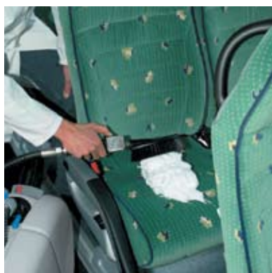
Удаление пены контролируется при помощи кнопки смонтированной на рукоятке щетки.
