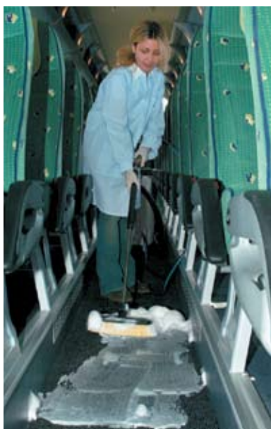
Удаление пены контролируется при помощи кнопки смонтированной на рукоятке щетки.
