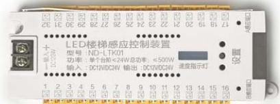
После пересечения человеком одного из 2-х датчиков, происходит последовательное включение ступенек. По завершении включения всех ступенек активируется таймер. Если люди пойдут одновременно с двух концов лестницы, то подсветка активируется полностью. Настройки контроллера: 5 режимов скорости; Возможность выбора количества управляемых каналов (ступеней 32)
