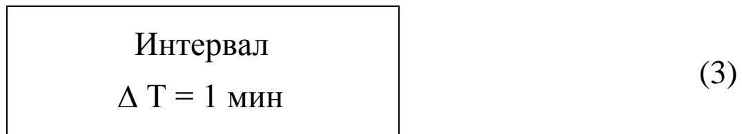
2.1.5.4 Кнопками ↓ (↑) установить требуемый интервал измерений (от 01 до 60 мин для ТЦЗ-МГ4.01 или от 01 до 180 мин для ТЦЗ-МГ4.03) и зафиксировать кнопкой **ВВОД**, после чего на индикаторе высвечиваются значения температуры, фиксируемые преобразователями  $T_1$  и  $T_2$ , например:
