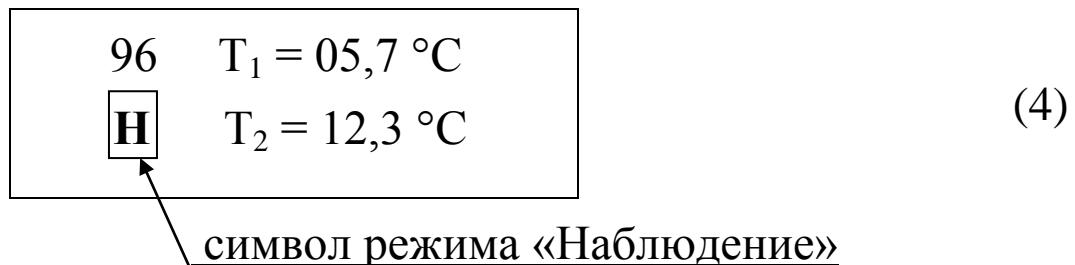
В дальнейшем термометр работает в автоматическом режиме, выполняя измерения через установленный интервал времени в течение установленной длительности наблюдений с записью в архив значений  $T_1$  и  $T_2$ , даты и времени измерений.
