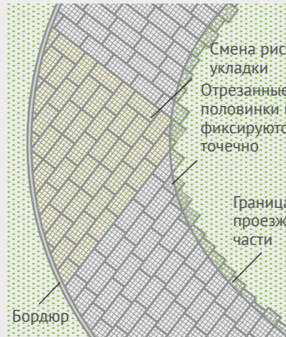
Рис. 16: На крутых поворотах можно менять направление укладки. В зависимости от нагрузки может потребоваться бордюр с одной стороны.
