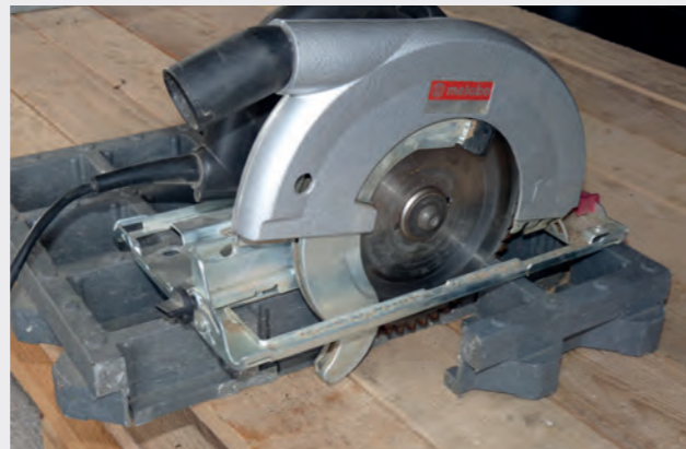
Подходящие для резки инструменты: круглые: циркулярная пила с твердосплавным диском прямые: электролобзик (с учетом высоты элементов)
