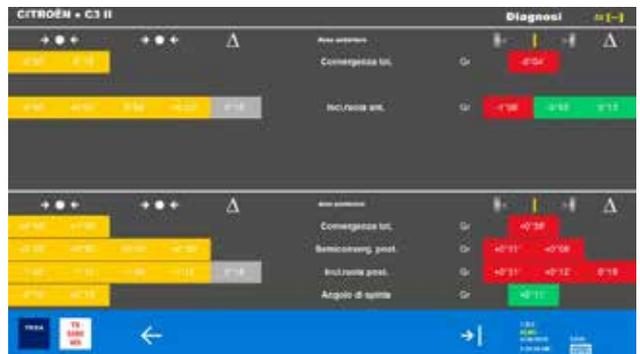
Изображение считываемых данных от четырёх датчиков CCD, сравниваемых с установленными производителем номинальных значений. Если значения попадают под допуски, то можно продолжить расположение RCCS 2.
