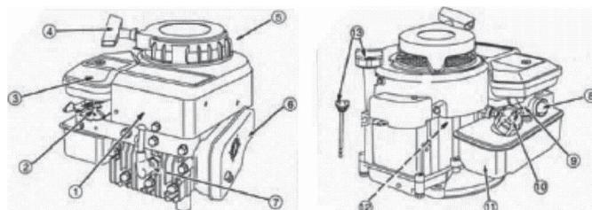
Основным элементом газонокосилки является 4-х тактный двигатель внутреннего сгорания, с вертикальной осью коленвала и его основные части: (2) - рычаг дросселя; (3) -фильтр воздушный; (4) - стартер ручной; (5) - защитный кожух; (6) - глушитель; (7) - свеча зажигания; (8) - кнопка топливного насоса; (9) - карбюратор; (10) - пробка бензобака; (11) - бензобак; (12) - корпус двигателя; (13) - маслоналивная горловина
