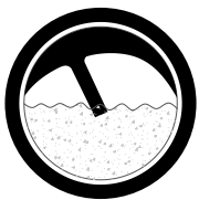
Рисунок В / Нормальная работа Дефлектор ниже оси визирования, утечки пара нет, конденсатоотводчик работает нормально.
