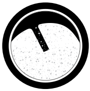
Рисунок С / Накопление конденсата Если индикатор потока полностью покрыт водой, следует понимать, что смотровое стекло установлено очень близко к системе, и в устройстве с теплообменом происходит накопление конденсата. В результате этого пропускная способность конденсатоотводчика оказывается недостаточной.
