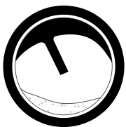
Рисунок D / Утечка пара Проходящий пар значительно покрыл водную поверхность. Пар заполнил область между дефлектором и поверхностью воды. Это означает, что конденсатоотводчик пропускает пар.
