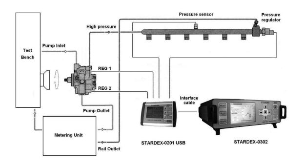
Примечание: при проверке некоторых насосов Bosch CP1, в которых установлен регулятор давления аналогичный регулятору давления, установленному в топливной шине для испытания шести форсунок (редукционный клапан), регулятор из насоса установить в топливную шину, а на его место в насосе установить специальную заглушку из комплекта поставки топливной шины.
