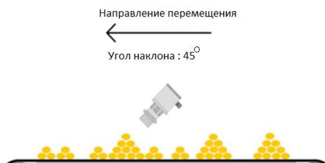
Рис. 2 Монтаж над ленточным конвейером
