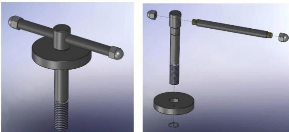
6.2.3 Установка хомута: Сначала установите хомут на верхнюю часть башни. См. рисунок. Затем установите ручной болт, звездочку, оси на хомут.
