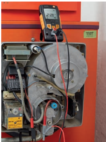
Измерение потока ионизации с testo 760
