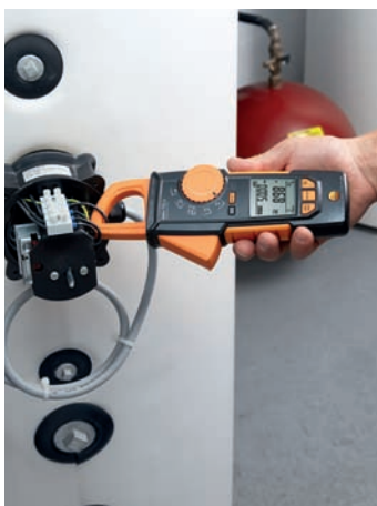
Измерение напряжения на бойлере с testo 770
