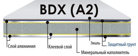
Панели обладают высокими огнеупорными характеристиками. Одобрены для использования в высотном строительстве, а также для зданий повышенной пожарной опасности в качестве облицовки фасадов, оконных и дверных проёмов, в устройстве внутренних углов зданий.
