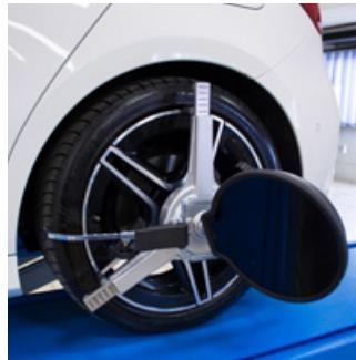
Set di 4 griffe a 3 punti autocentranti, prive di compensazione, che consentono una misurazione rapida e precisa. Fornite di sistema di movimento rapido ed unghie in materiale ABS; non prevedono nessun contatto metallo con metallo.
