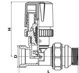
4.3. Клапаны терморегуляторов, осевые угловые
