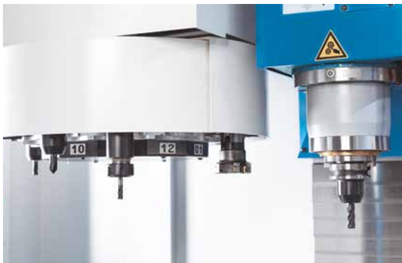
Надежное 12-позиционное горизонтальное устройство смены инструмента
