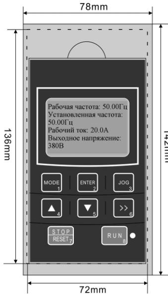
Установочные размеры защелки клавиатуры: 136\*72мм
