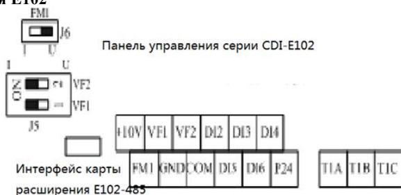
Ниже изображена схема подключения контура управления и основного контура серии E102 (к модели S2 не подключается L3).
