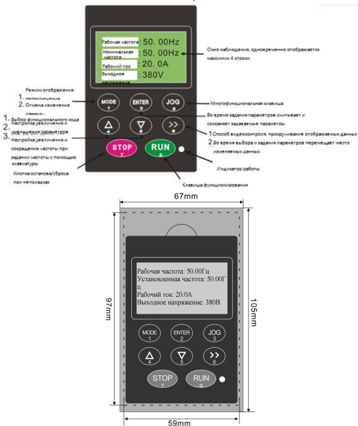
Установочные размеры защелки клавиатуры: 97\*59мм
