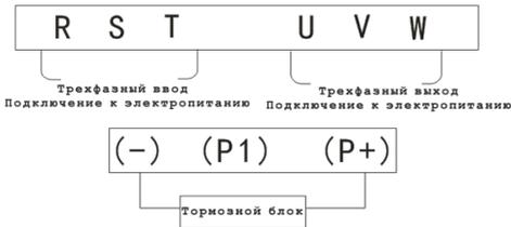
Схема подключения главных контуров 9 механизмов серий E100 и E102:
