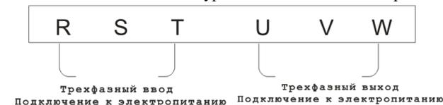
Подключение главных контуров 11 механизма серии E180:
