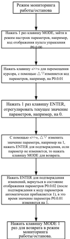
Пример: ниже приведен пример изменения значения параметра времени ускорения P0.0.11 с 010.0 до 016.0
