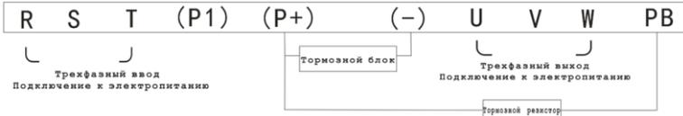
Схема подключения главных контуров 6 и 7 механизмов серий E100 и E102:
