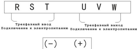
Схема подключения главных контуров 10 механизмов серий E100 и E102:
