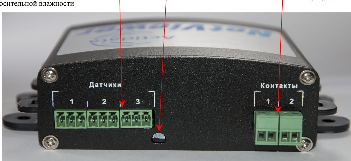
**Рисунок 3. Вид разъемов с обратной стороны модели контроллера Actidata NV1**
