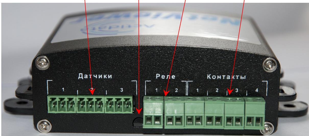
**Рисунок 4. Вид разъемов с обратной стороны модели контроллера Actidata NV1.1**
