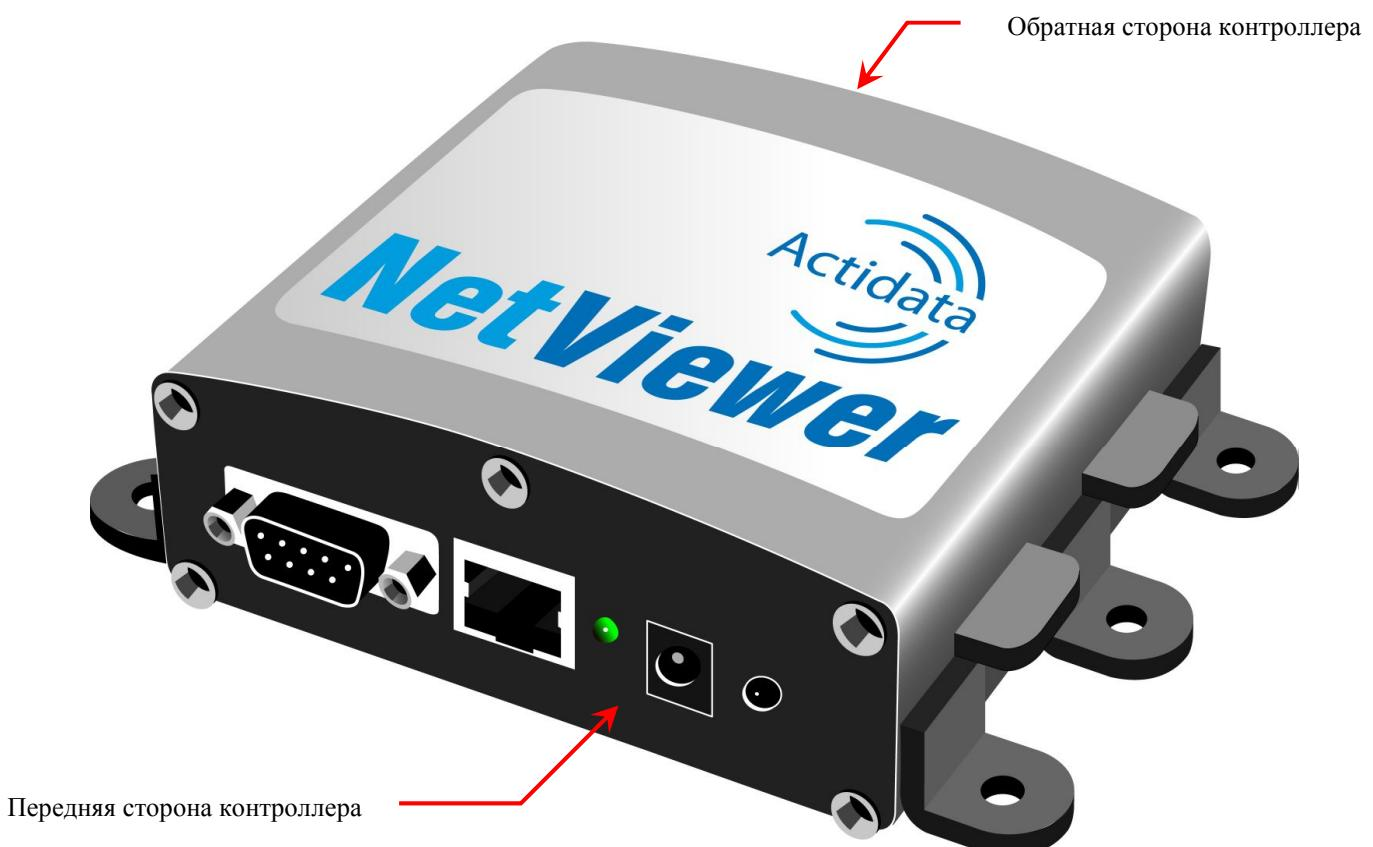
**Рисунок 1. Внешний вид контроллеров Actidata NV1 и NV1.1**
