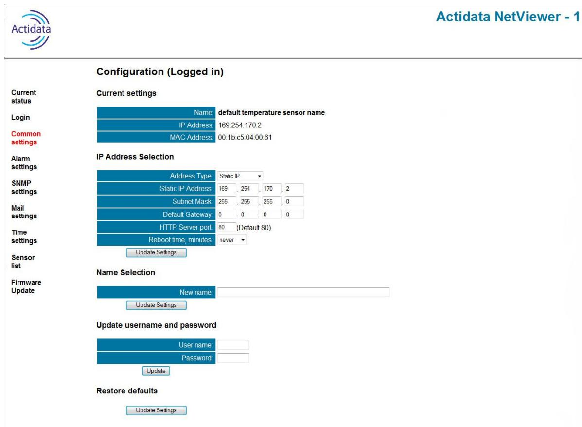
**Рисунок 11. Страница «Common settings - Configuration» («Общие параметры настройки - Конфигурация»)**
