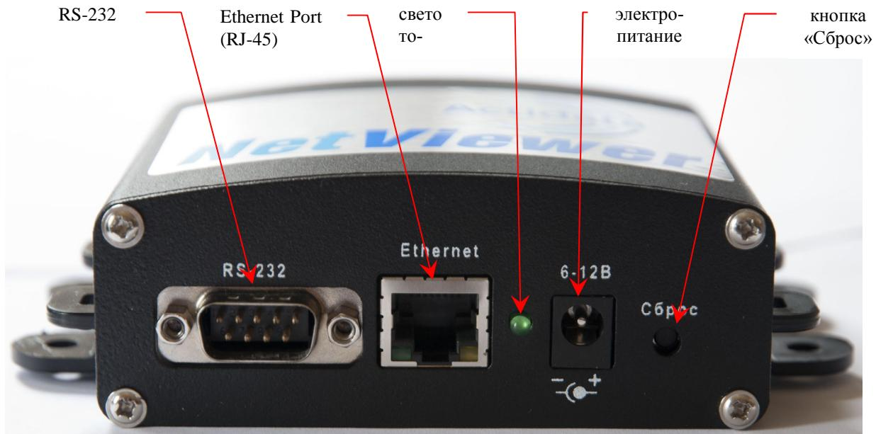
**Рисунок 2. Вид разъемов на передней стороне контроллеров Actidata NV1 и NV1.1**
