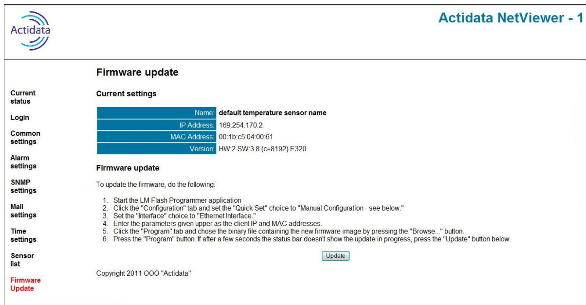
**Рисунок 27. Страница «Firmware update» («Обновление прошивки»)**
