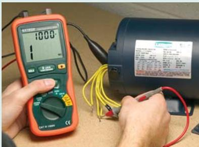
Измеряет сопротивление изоляции двигателей.
